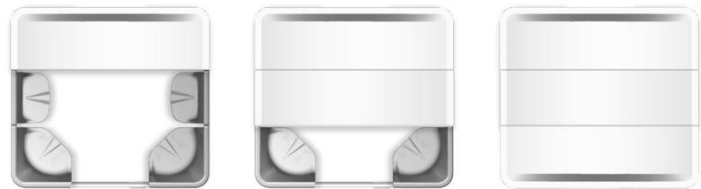
Välj ut den taksektion som skall ha utsugventil borra hål och fäst utsugtsdon innan taksektionerna limmas och monteras (se exempel sid. 35). Ventikanalen är enklast att ansluta innan hela taket är monterat.
