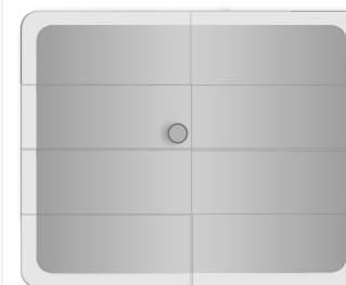
Elegir la sección de techo que va a tener agujero de salida de aire, taladrar el agujero antes de encollar y montar las secciones del techo (ver ejemplo en página 35). Lo más fácil es conectar el canal de ventilación antes de montar todo el techo.
